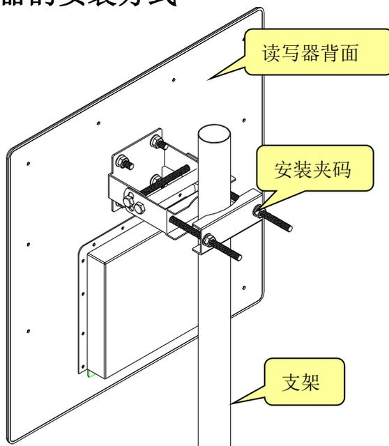
读写器立架安装方式有两种：“侧面 1 字型安装”和“L 立架型安装”见下图：可以根据应用需求与现场实际来选择安装方式，一般情况下侧装读写距离近些，但安装简单；顶装方式读写距离远些，但安装复杂。
