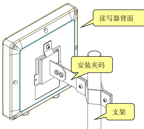
读写器立架安装方式有两种：“侧面 1 字型安装”和“L 立架型安装”见下图：可以根据应用需求与现场实际来选择安装方式，一般情况下侧装读写距离近些，但安装简单；顶装方式读写距离远些，但安装复杂。
