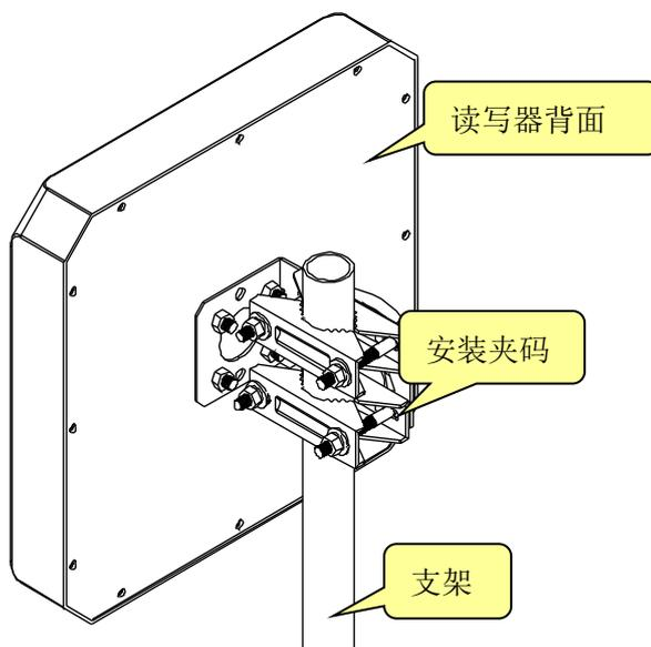
读写器立架安装方式有两种：“侧面 1 字型安装”和“L 立架型安装”见下图：可以根据应用需求与现场实际来选择安装方式，一般情况下侧装读写距离近些，但安装简单；顶装方式读写距离远些，但安装复杂。
