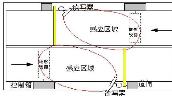
b) 现场安装方式二：道路有中间隔离的安全岛，控制设备（道闸）安装在中间隔离的安全岛上，车辆速度以小于10公里/小时通过读卡区域。
